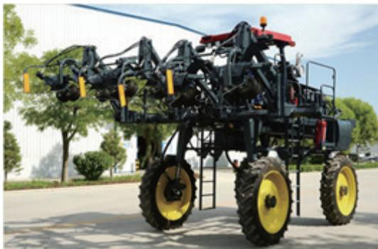
Figure 10 OK104-3CX detasseling machine<sup>[29]</sup>
