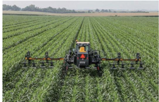
Figure 8 204SP detasseling machine<sup>[15]</sup>
